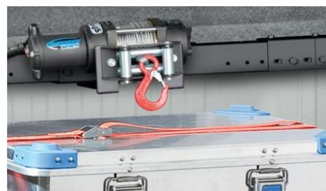
Système de treuil pour la benne avec grille de protection
