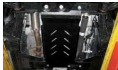
Protection de caisse pour le moteur et le radiateur 5 mm en aluminium
