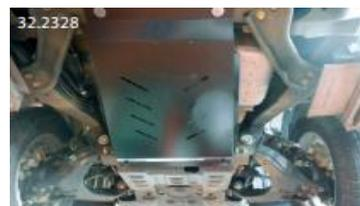
Protection de caisse pour le moteur et le radiateur 3 mm en aluminium pour les modèles 2012+
