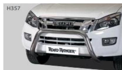
Arceau de protection de 63 mm avec barre transversale DC/CC pour les modèles 2012 et 2017
