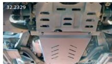
Protection de caisse (radiateur, moteur, boîte et démultiplicateur) DC + CC
