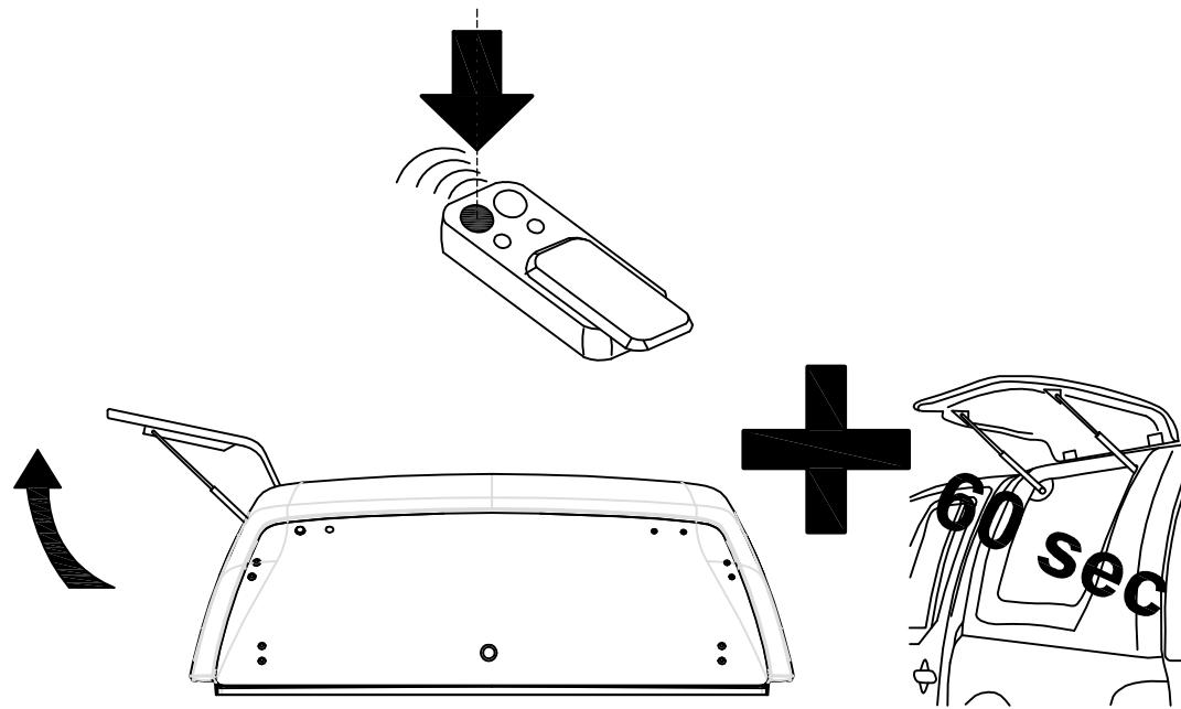
Beim öffnen der Seitenklappe schaltet sich die Innenleuchte automatisch für 60 sekunden ein.
