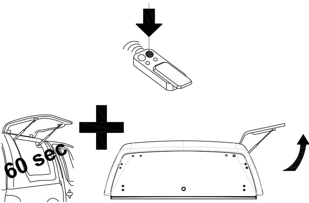
Beim öffnen der Seitenklappe schaltet sich die Innenleuchte automatisch für 60 sekunden ein.
